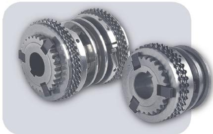
Муфта LSV / сдвоенная муфта LSV может быть включена и выключена при полной нагрузке. Реверс в обычных обстоятельствах возможен на малых оборотах и при низкой мощности, при этом должны выдерживаться паузы между переключениями (примерно 6 сек.). В исключительных случаях возможен так называемый аварийный реверс, т.е. Переключение муфты в противоположное состояние на максимальных оборотах и при максимальной мощности.
